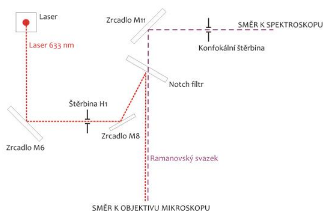
Obrázek 3.17: Zjednodušené schéma mikrospektrometru HR800 (převzato z Šípová, 2006).
