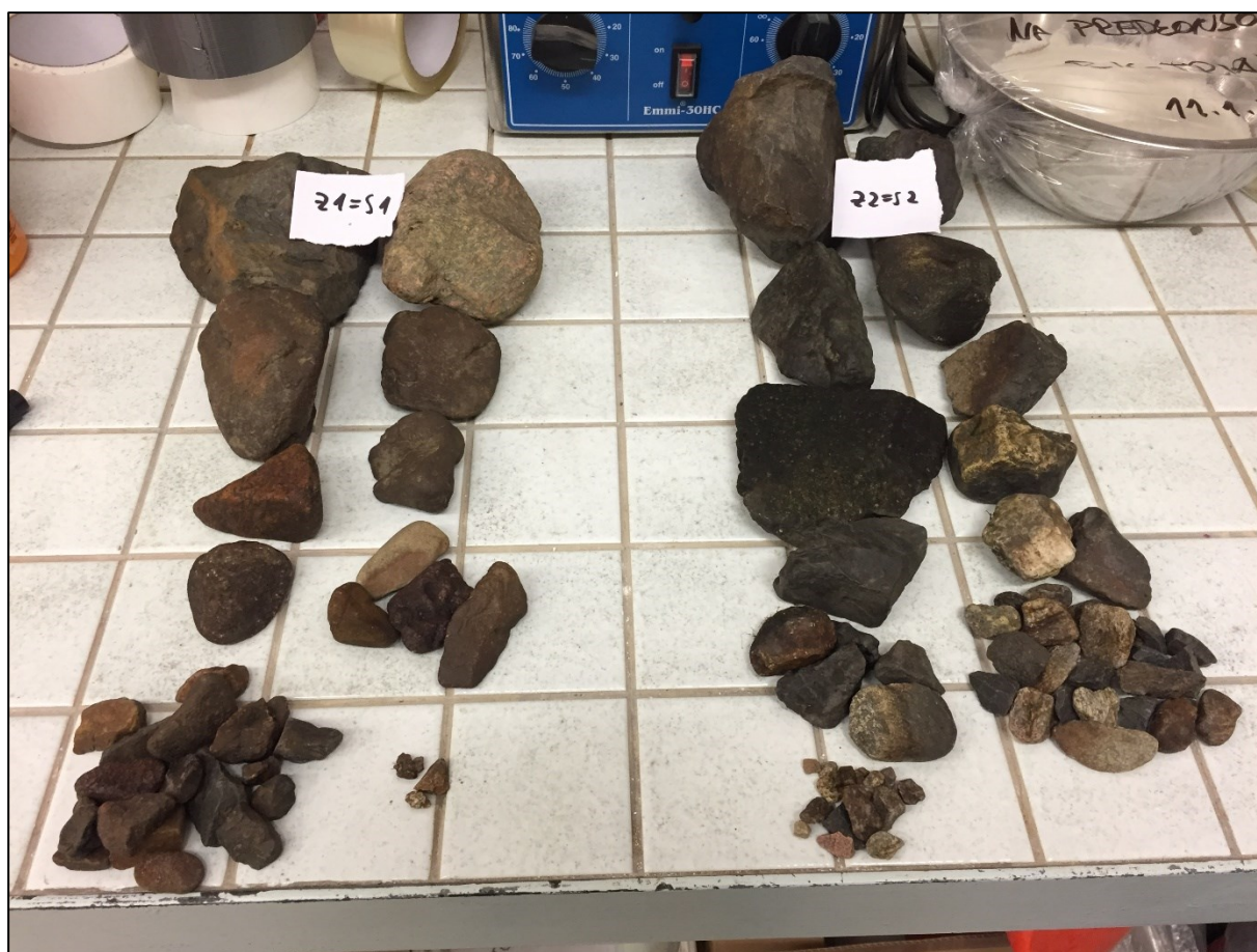
Obr. 25 – Relativně pravidelný tvar zrn krycí vrstvy odběrných míst Z1, resp. Z2. Zdroj: (foto Miroslav Jonáš, terénní průzkum)
