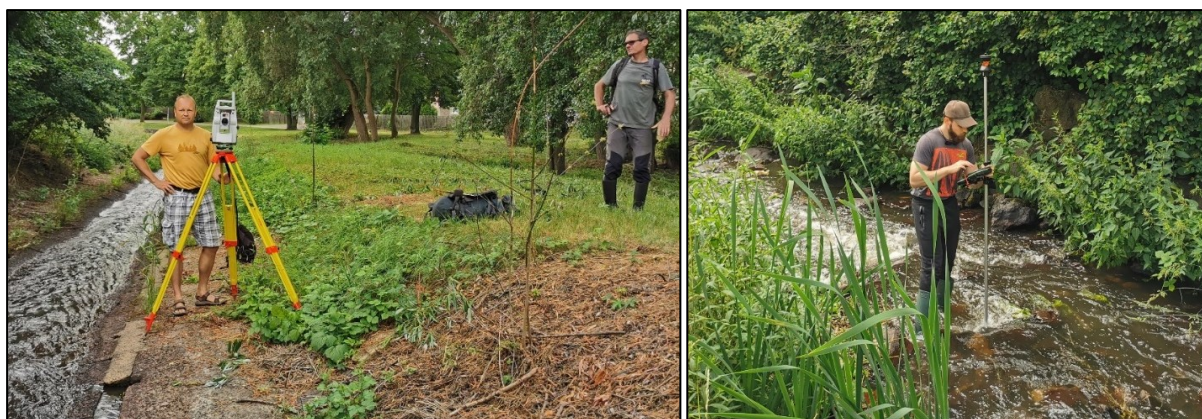
Obr. 17 – Ukázka geodetických zaměřovacích prací. Vlevo – přesuny stativu s totální geodetickou stanicí podél celé trasy úseku. Vpravo – zaměřování bodů podélného profilu pomocí zaměřovacího krystalu. Zdroj: (foto Milada Matoušková).
