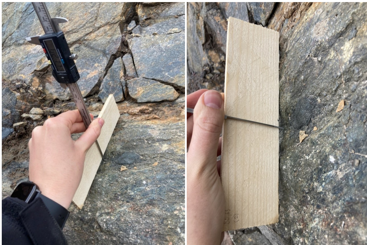
Obr. 13 – Příklad měření JRC v terénu na průběžné diskontinuitě v lomu Zdechovice pomocí metody amplitudy a rovné hrany. Rovnou hranu zde reprezentuje rovnoměrně uříznutá lať s délkou hrany 20 cm. Velikost amplitudy se měří pomocí digitální šuplery podél latě a zaznamenává se největší naměřená hodnota. Na základě největší hodnoty amplitudy a známé délky profilu se určí velikost hodnoty JRC.
