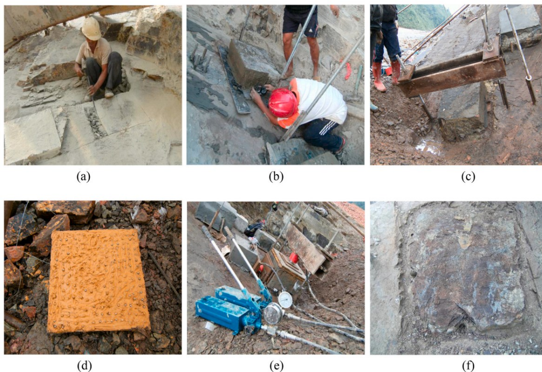
Obr. 6 – Postup přípravy těles v horninovém masivu a znázornění samotné přímé smykové zkoušky in-situ . (a) Nejprve se tělesa ve svahu šetrně opracovala kamennou pilou tak, aby nedošlo k porušení horninového masivu. Následně se zbytky okolního masivu odtěžily ručně pomocí pneumatického kladiva a jiných pomůcek. (b) Nerovnosti na boku tělesa se zahladili maltou a byl instalován snímač pro měření posunu. (c) Mimo připravené těleso se do masivu instaloval kotelní prvek pro zajištění normálové reakce. Na kotelní systém instalovali H-průvlak ve vodorovné poloze sloužící jako rám pro zajištění aplikace zpětného napětí. (d) Na kontakt smykové aparatury se zkoušeným tělesem se umístili dvě ocelové desky, mezi kterými bylo rozmístěno několik set ocelových kuliček s průměrem 12 mm. Kuličky měly snížit tření během zkoušky. (e) Následně se nad a za těleso umístili hydraulické válce pro aplikaci zatížení. (f) Po skončení zkoušky a demontáži aparatury byl zaznamenán stav a rozměry smykové plochy. Zdroj: Tan et al., 2021.
