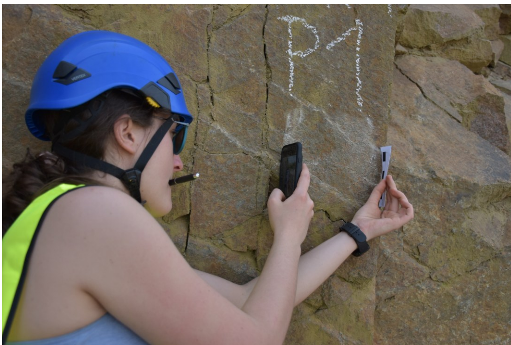
Obr. 20 – Možný způsob stanovení JRC v terénu vizuální metodou podle standardních profilů od Bartona a Choubeyho (1977). Na kontaktu s povrchem diskontinuity a rovnou hranou papírku s měřítkem 10 cm vznikne po přiložení k povrchu diskontinuity prázdný prostor. Díky vizuálnímu zhodnocení velikosti a různorodosti prostoru mezi přímoú hranou papírku a samotným povrchem diskontinuity a porovnáním se standardními profily je terénní pracovník schopen zhruba odhadnout interval hodnot JRC. Terénní měření na fotkách probíhalo v lomu Zdechovice. Foto.: Ing Jan Malík
