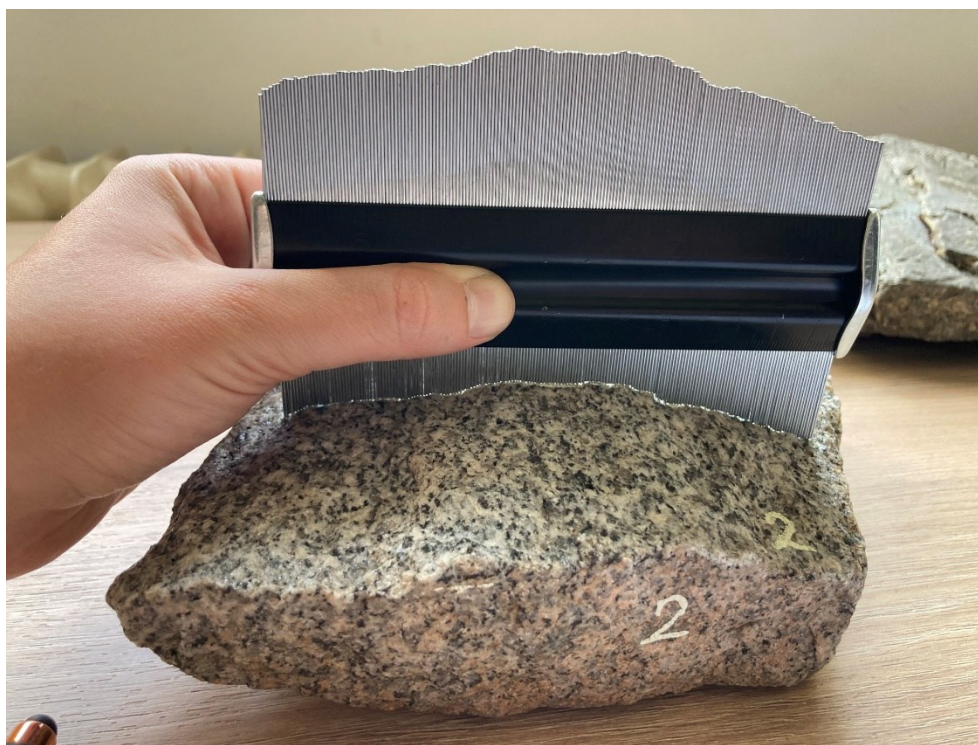
Obr. 17 – Profilovací hřeben s délkou 15 cm. Na centrální černé části hřebenu je měřící stupnice v centimetrech, která na obrázku není vidět kvůli světlu. Obrázek znázorňuje použití profilovací hřebenu za účelem získání detailního profilu drsnosti z povrchu diskontinuity.
