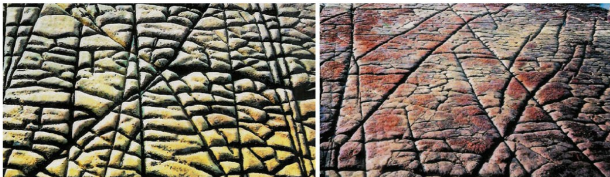
Obr. 28 - „Vlnami obroušené vrstvy dolomitu v Kimmeridge Bay břidlicích, vykazující výrazné známky předchozí anizotropie napětí “ (Barton a Quadros, 2015). Ve směru od shora dolů probíhá soustava hladkých rovinných diskontinuit, které v jiných směrech protínají mladší drsnější diskontinuity vzniklé za nižší anizotropie napětí. Zdroj: Barton a Quadros, 2015
