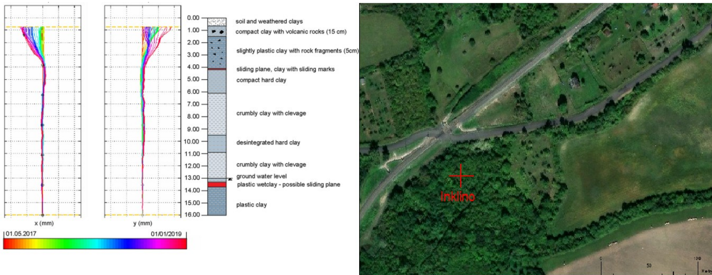
Obr. 21 - Inklinometrické měření z roku 2017 - 2019 se situační mapou. Nepublikované měření J. Balka.
