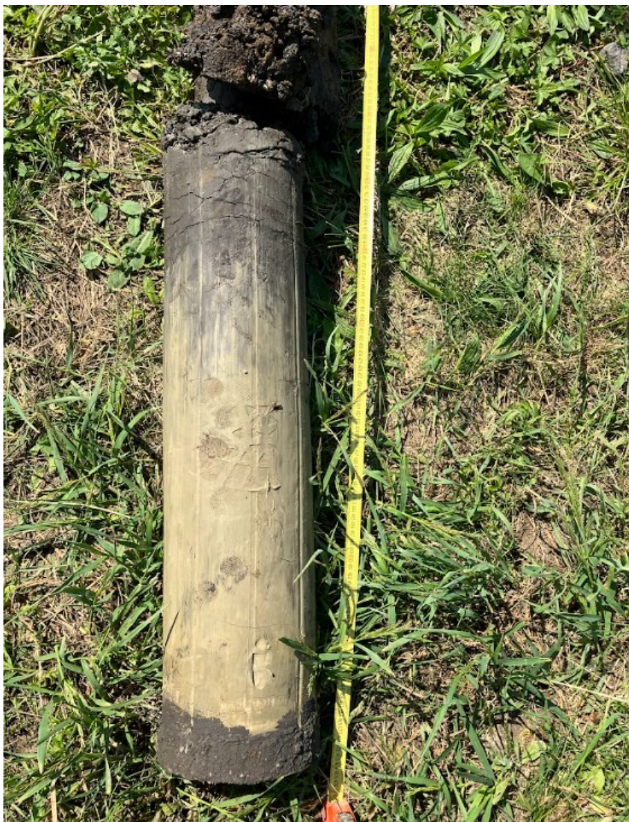
Obr. 45 - Slínovec velmi zvětralý - přechod z hnědé barvy do šedé, vysoký obsah limonitu - GT4. Valdštejsko, 2025.
