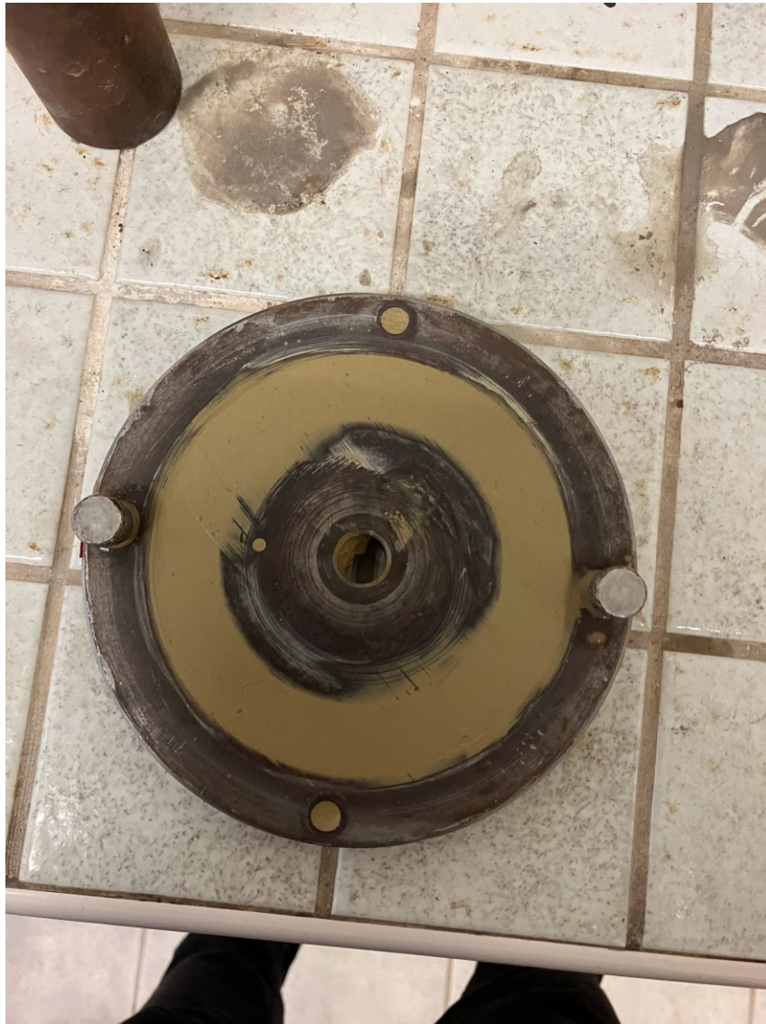
Obr. 32 - Zemina aplikována do rotační komory.
