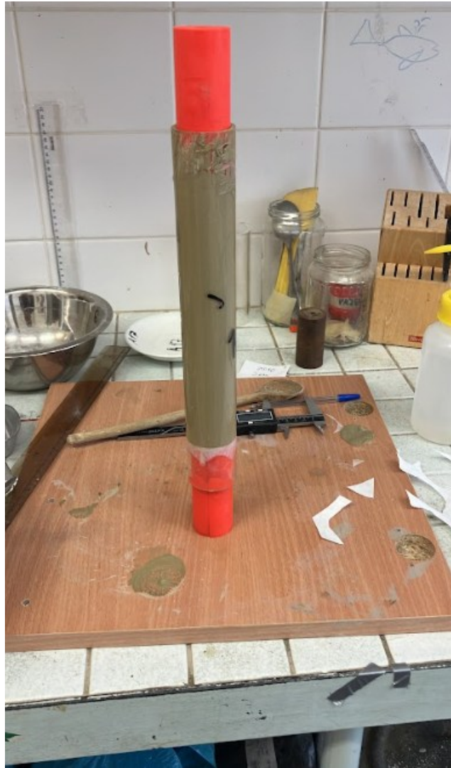
Obr. 29 - Příprava vzorku pro konsolidaci.
