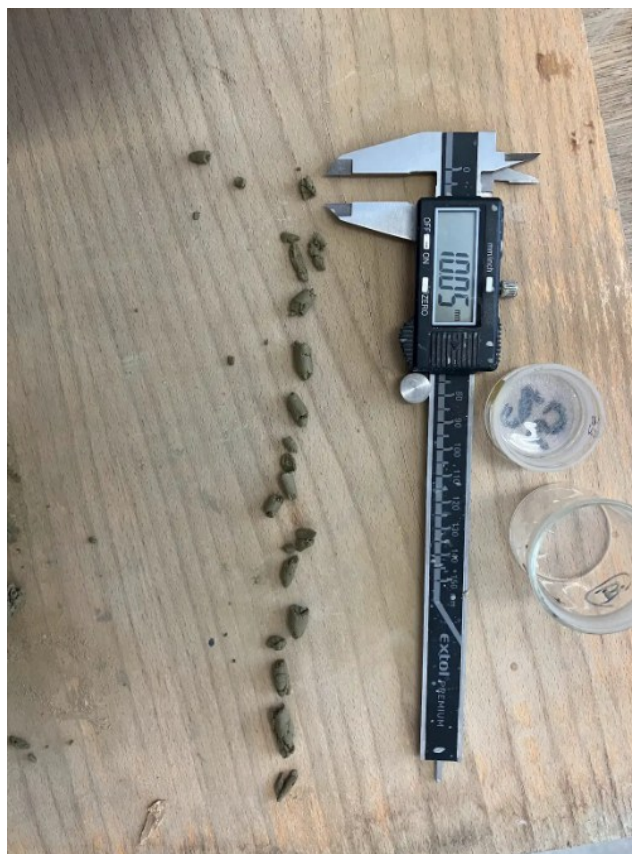
Obr. 28 - Válečková zkouška pro výpočet vlhkosti na mezi plasticity.
