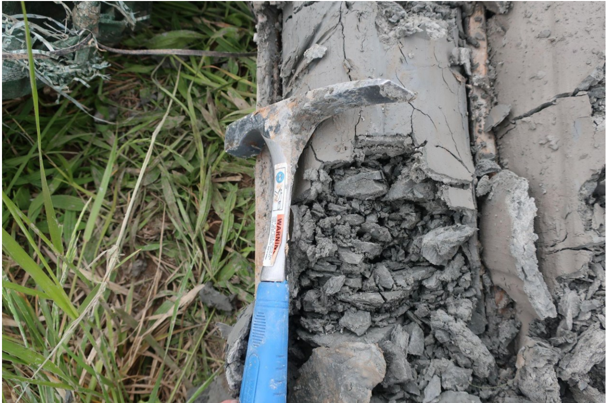
Obr. 46 - Slabě zvětralý slínovec šedé barvy - GT5. Valdštejnsko, 2025.
