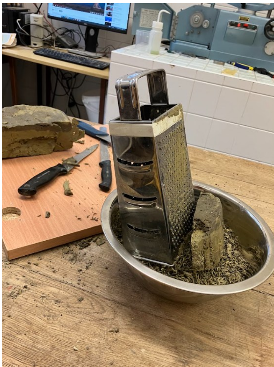
Obr. 27 - Strouhání jádra v rámci přípravy rekonstituovaného vzorku.
