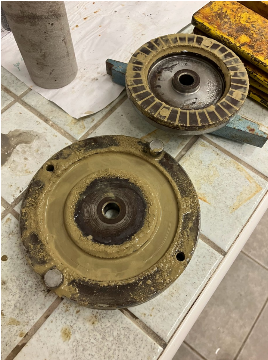
Obr. 33 - Zemina v rotační komoře po ukončení zkoušky.
