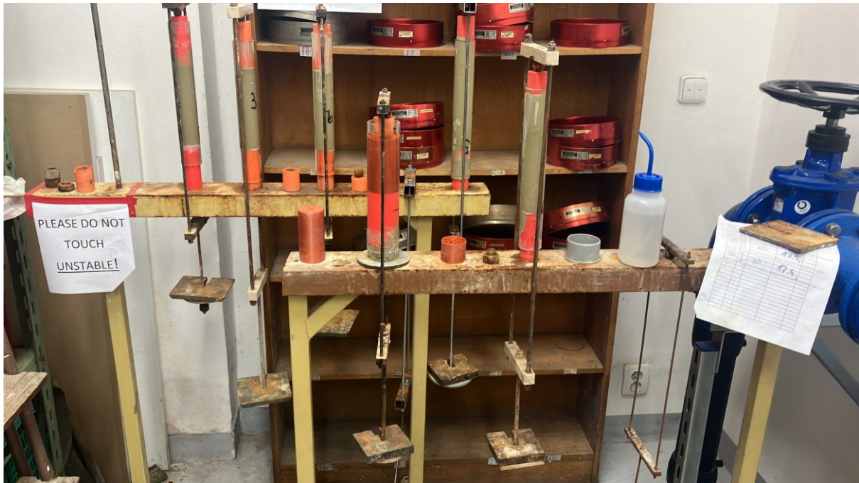
Obr. 30 - Konsolidování vzorků pro triaxiální zkoušku, první zatížení - sklad IG/HG.
