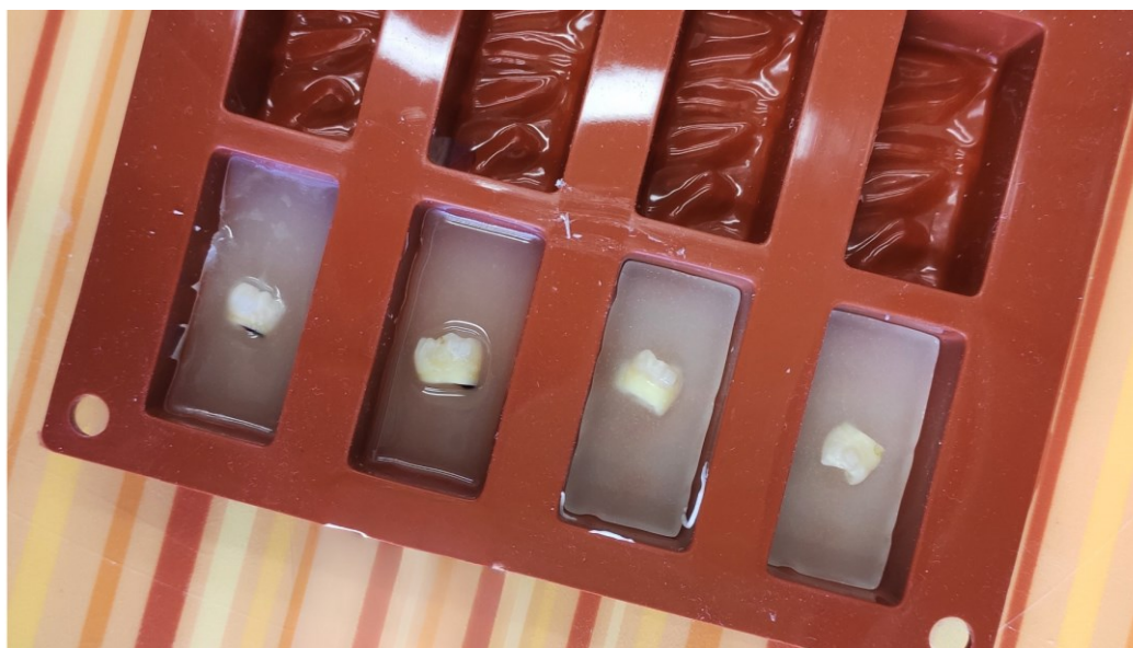
Obrázek 9 Zalití vzorků do pryskyřice
