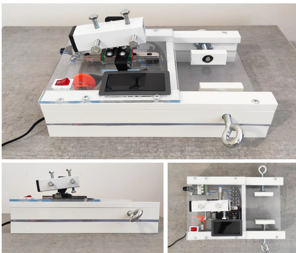
Obrázek 8 Experimentální lineární čistící zařízení
