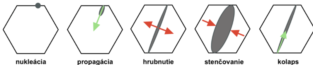
Obr. 5: Schematická reprezentácia fáz dvojčatenia (zelená šípka – smer pozdĺž roviny dvojčatenia, červená šípka – laterálny smer rastu).
