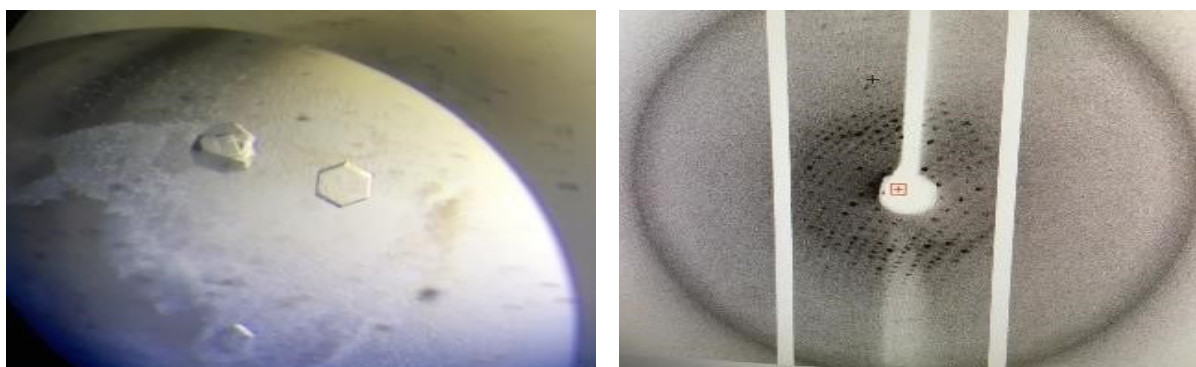
Obr. 11 Ukázka difrakčního obrazce: Krystal proteinu \Delta 42\_CpNce103p z podmínky 200mM octan amonný, 100mM octan sodný pH 4.6, 20% (w/v) PEG 4000 a jeho difrakční obrazec
