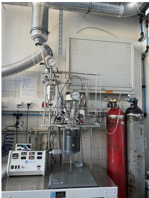
Obr. 4.1 Vsádkový autokláv Paar, připojen na tlakové nádoby obsahující vodík a dusík, hlavní reaktor (uprostřed) je vybaven tlakoměrem a systémem pro kontrolu teploty, zásobní reaktor (vlevo nahoře) je také vybaven tlakoměrem a je od hlavního reaktoru oddělen řadou uzávěrů
