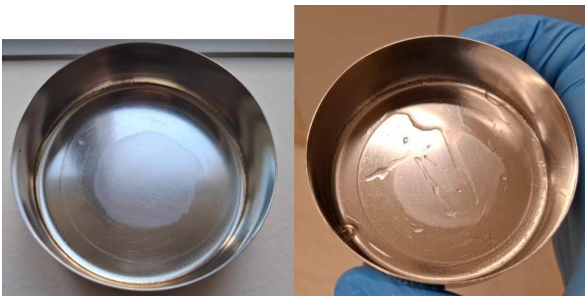
Obrázek 10: Vlevo je nerezová miska ihned po extrakci methanolem při experimentu s IR filtry. Mimo samotnou šedou stopu cytostatika, které bylo po 30 sekundách extrahováno a převedeno do HPLC vialky, lze pozorovat i zachovalou kružnici po IR-filtru. Vpravo je stejná miska po pěti hodinách v alkalické lázni a po ošetření čistým ethanolem. Vizuálně nedošlo k žádné změně povrchu a obě dvě stopy zůstávají ve stejné velikosti.
