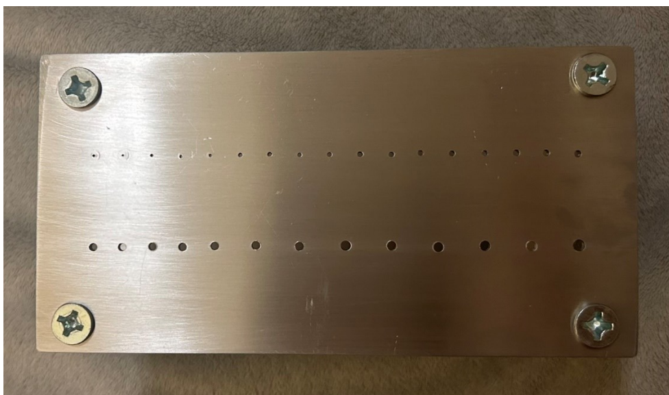
Obrázek 35: Průchozí otvory na měřicí desce
