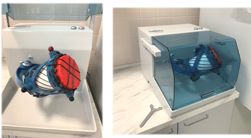
Mísicí nádoba umístěná v zařízení TURBULA® s otevřeným a uzavřeným ochranným krytem
