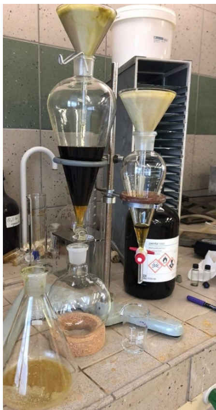
Obrázek 21. LLE – filtrace a následné oddělování fází pomocí děličky
