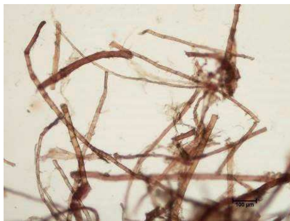
Obr. 19 Lýková vlákna vybarvená Graffovým „C“ roztokem. Konce vláken jsou většinou bez podélného štěpení. Na vlákních jsou patrné příčné rýhy a posunutí.
