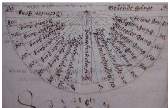
Obr. 31 Pomůcky pro výpočet sklonu, úhlů a šikmých délek pásma nebo lana při měření směru štol.
