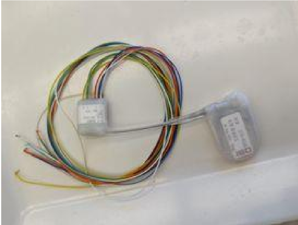
Obrázek 7 – Biotelemetrický implantát. Vlevo je snímací modul, vpravo telemetrický modul.
