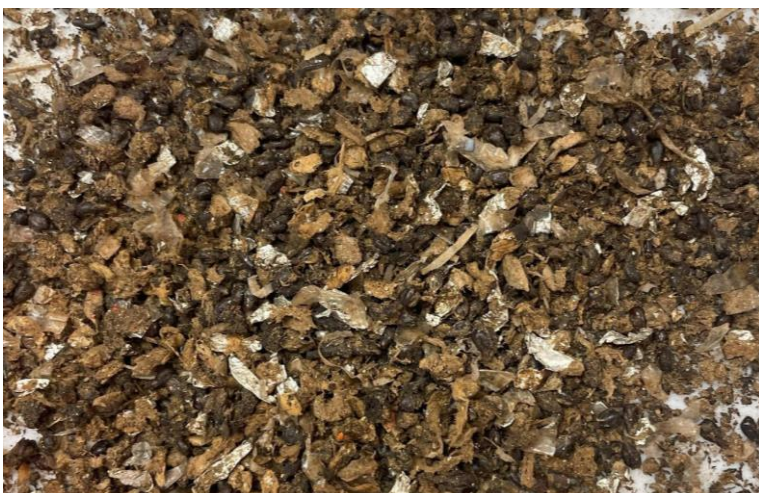
Obrázek A 11 - Přesítovaná varianta „cigaretová drť + kal“ o frakci 6–10 mm – pilotní test s cigaretovou drtí
