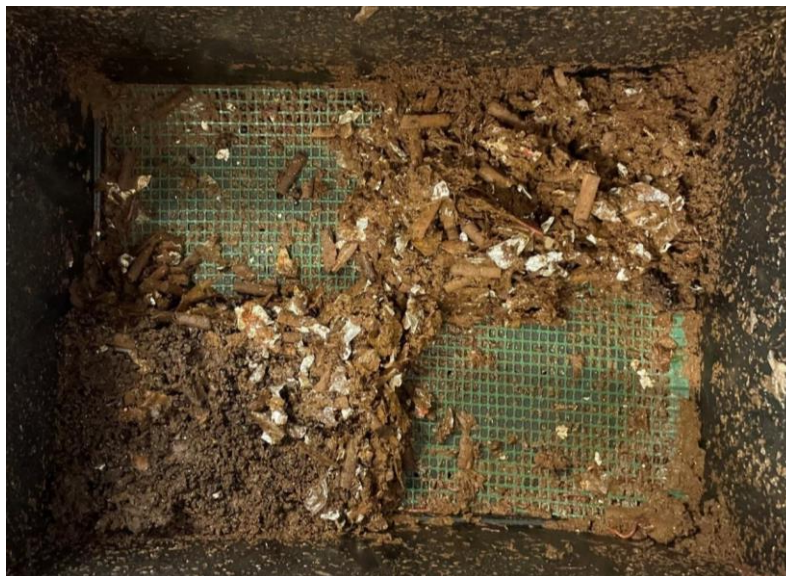
Obrázek 4 - Odebrání dvou protilehlých čtvrtin při ukončení pokusu s cigaretovou drtí
