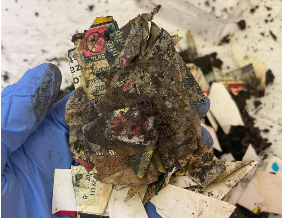
Obrázek A 2 - Stav vermikompostu s krabičkami – míra rozkladu krabiček v laboratorním pokusu s jednotlivými materiály
