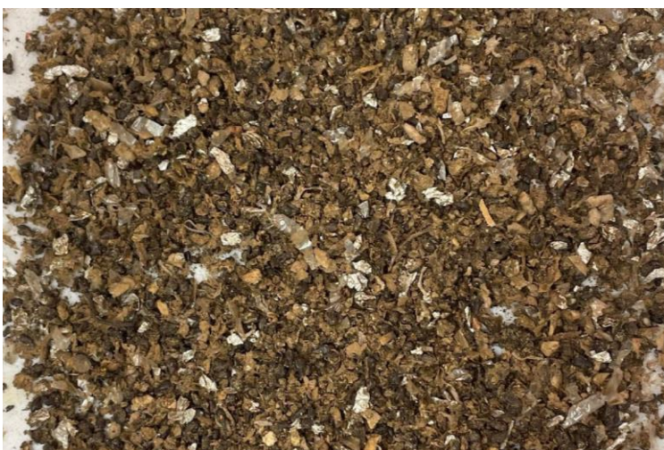
Obrázek A 12 - Přesítovaná varianta „cigaretová drť + kal“ o frakci <6 mm – pilotní test s cigaretovou drtí
