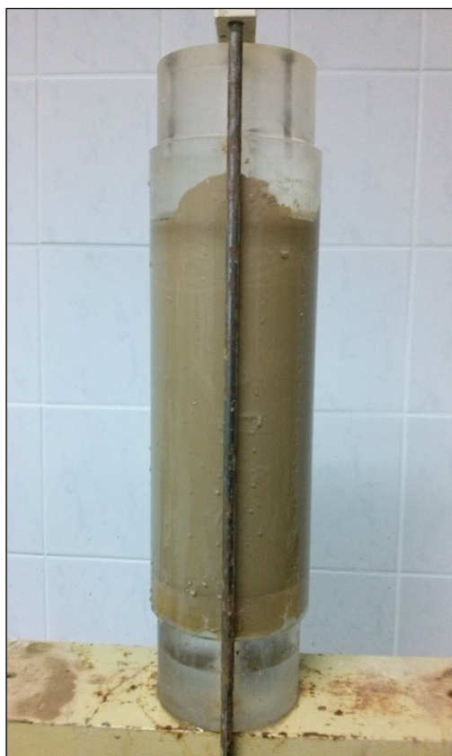
Obr. 54: Konsolidace rekonstituované zeminy v konsolidometru.
