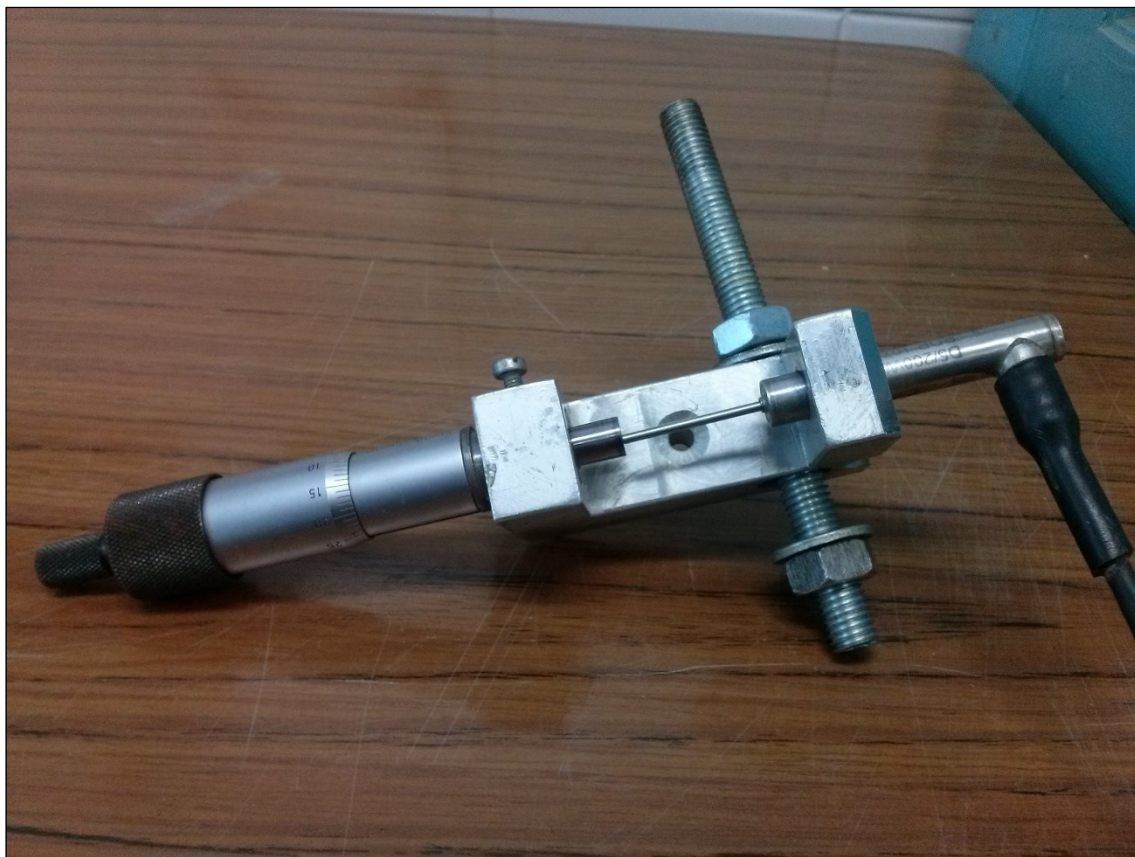
Obr. 68: Držák na kalibraci snímače LVDT pomocí mikrometru.
