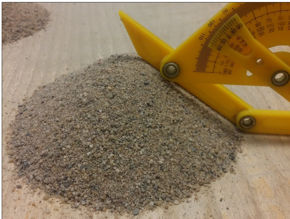
Obr. 56: Měření úhlu přirozené sklonitosti písku.
