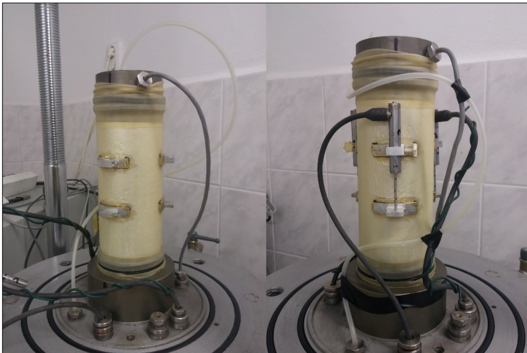
Obr. 61: Přichycení LVDT snímačů na triaxiální vzorek nenasycené zeminy; vlevo – držáky LVDT snímačů, vpravo – osazené LVDT snímače.
