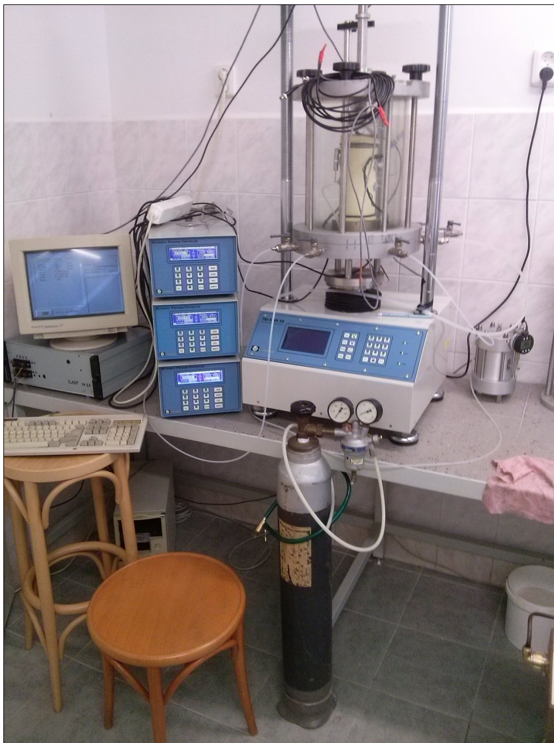
Obr. 65: Triaxiální systém pro zkoušky nenasycené zeminy, použitý v rámci prezentovaného výzkumu – triaxiální komora VJ Tech, zatěžovací lis VJ Tech (Tri-scan 50), úchylkoměr Mahr, 3 kontroléry tlaku VJ Tech, externí měřidlo změny objemu vzorku s úchylkoměrem Mahr, tlaková lahev se stlačeným vzduchem, snímače LVDT (RDP Electronics), bender elementy, počítačový systém.
