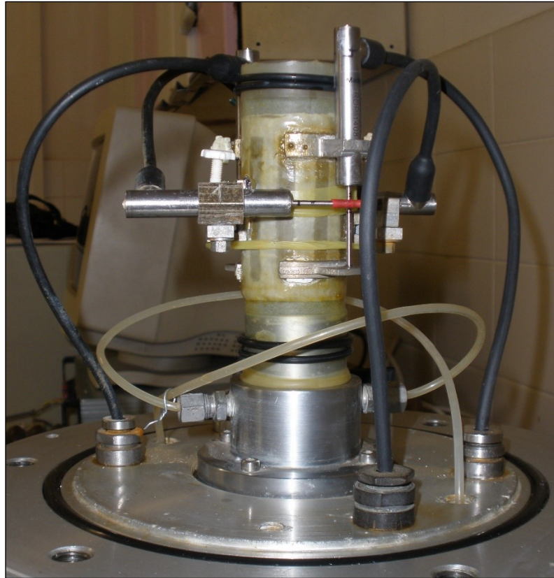
Obr. 4: Připevnění axiálních a radiálních LVDT snímačů na triaxiální vzorek zeminy.
