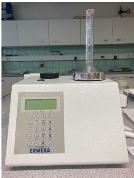
Obrázek č. 17: Přístroj na stanovení zdánlivých objemů prášků Erweka SVM 102
