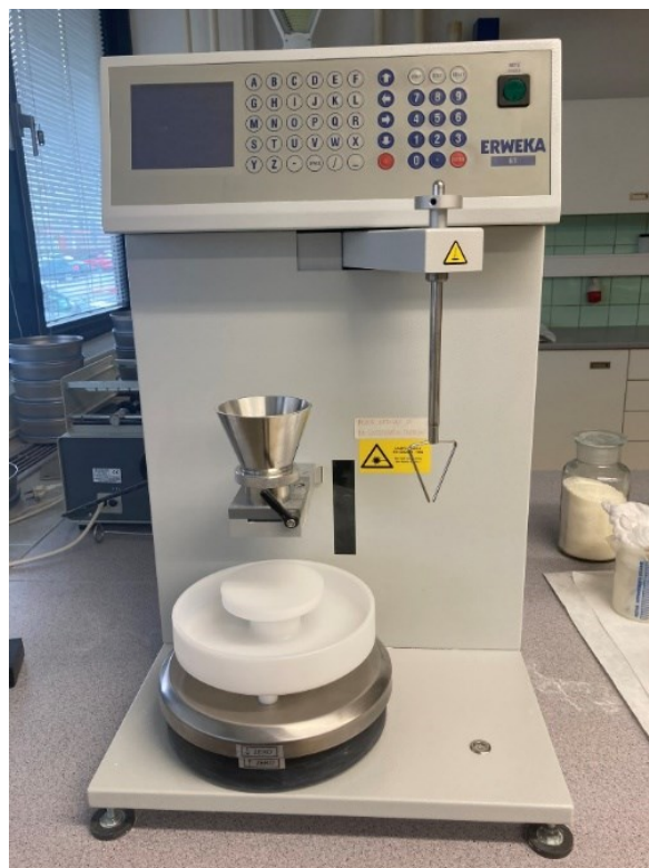
Obrázek č. 16: Přístroj na stanovení sypnosti Erweka GT
