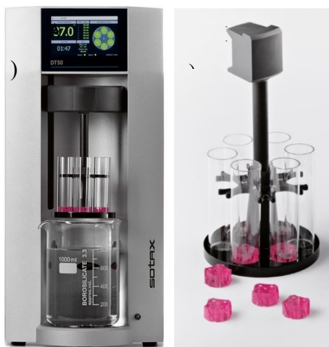
Obrázek č. 21: Přístroj na měření rozpadu tablet – SOTAX DisiTest 50 A) celý přístroj, B) magnetické rameno s trubičkami a magnetickými disky [49]
