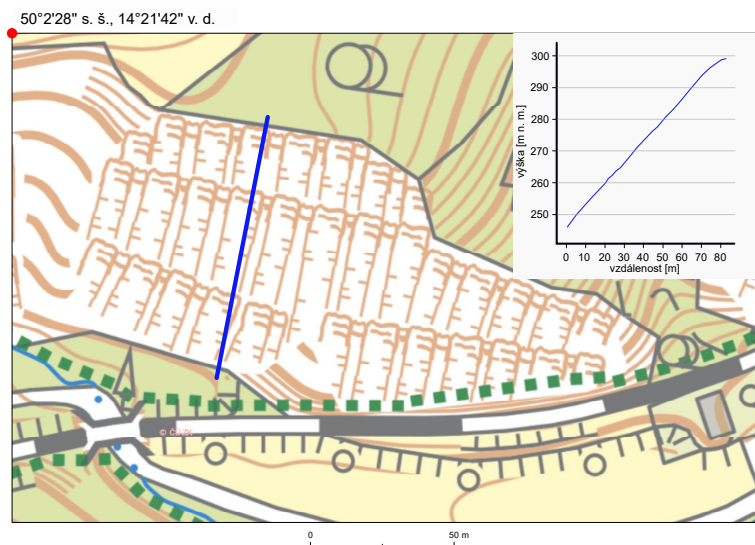
Obr. 49: Ukázka skalního útvaru s lomovými hranami využitými primárně pro grafické vyplnění plochy polygonu. Pro názornost doplněn podélný profil skalním útvarem – stopa profilu znázorněna modrou linií. Výřez z digitální verze ZM 10.
