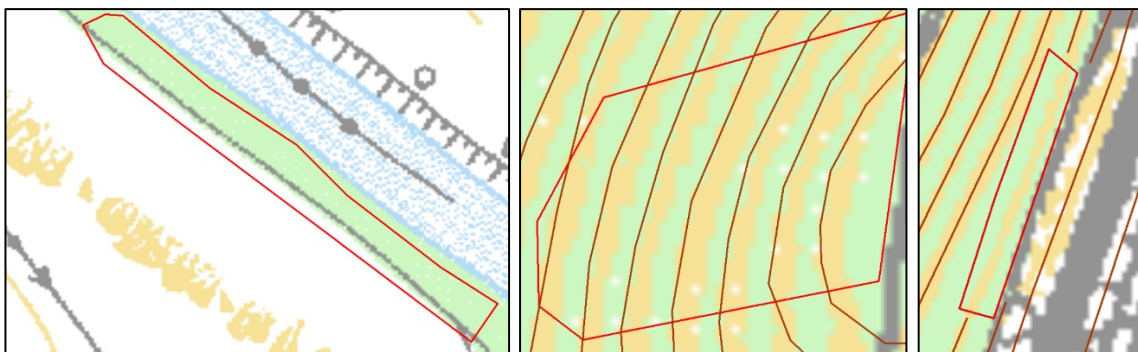
Obrázek 24: Ukázka prostorové neshody polygonů skalních útvarů a kresby skal na rastrové mapě.
