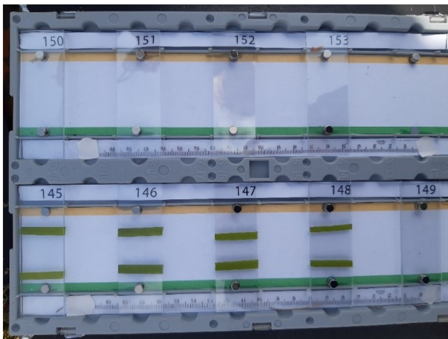
Obrázek 13 - Pomůcka pro měření povrchu vzorku listu trav metodou fotografování s měřítkem a následná analýza obrazu
