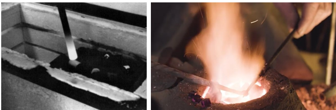
Obr. 2) Vlevo: technika nabírání kousků skla na horký trn (Podle: STERN 2012, 37); vpravo: technika vinutí korálku na železný trn, který řemeslník drží v levé ruce, zatímco v pravé ruce drží tyčku s roztaveným sklem, které navíjí na trn. Podle < https://www.youtube.com/watch?v=62ltg2yCgwo - 2:54 (Navštíveno 30.7.)
