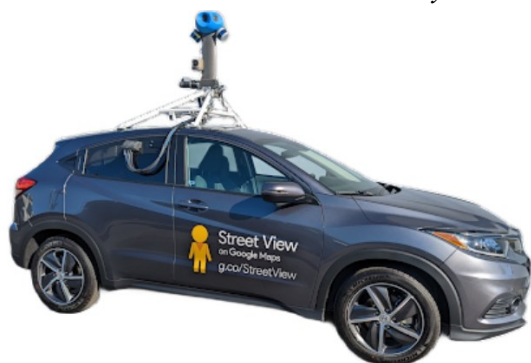
Obrázek 3: Příklad všesměrové kamery na střeše
