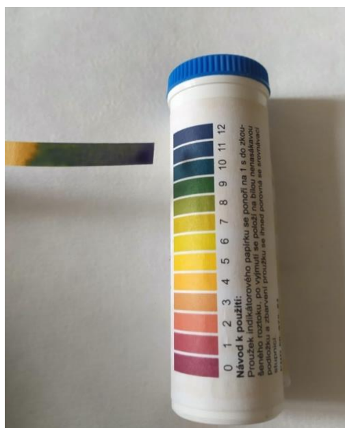
Obrázek 17: Porovnání zabarvení pH vzniklého roztoku hydroxidu sodného s pH stupnicí
