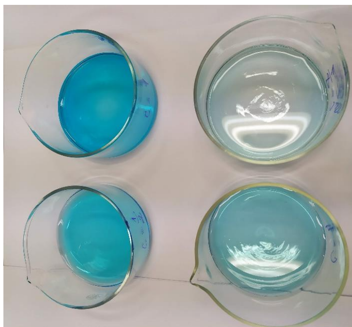
Obrázek 6: Roztoky modré skalice před krystalizací
