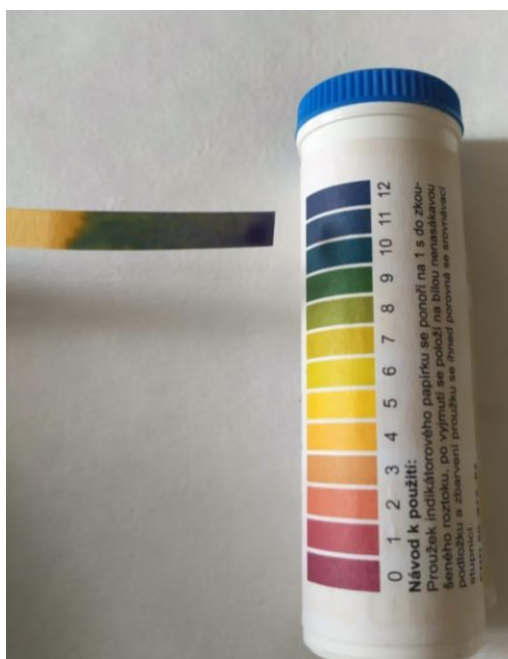
Obrázek 14: Porovnání zabarvení pH vzniklého roztoku hydroxidu draselného s pH stupnicí
