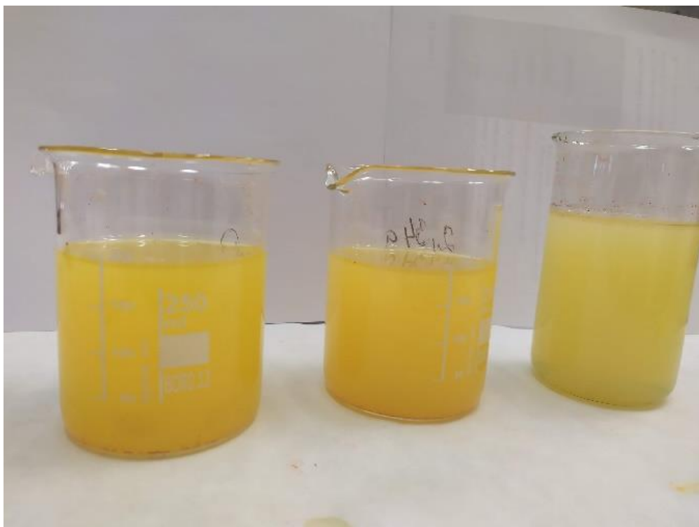
Obrázek 4: Roztok po přidání dusičnanu stříbrného
