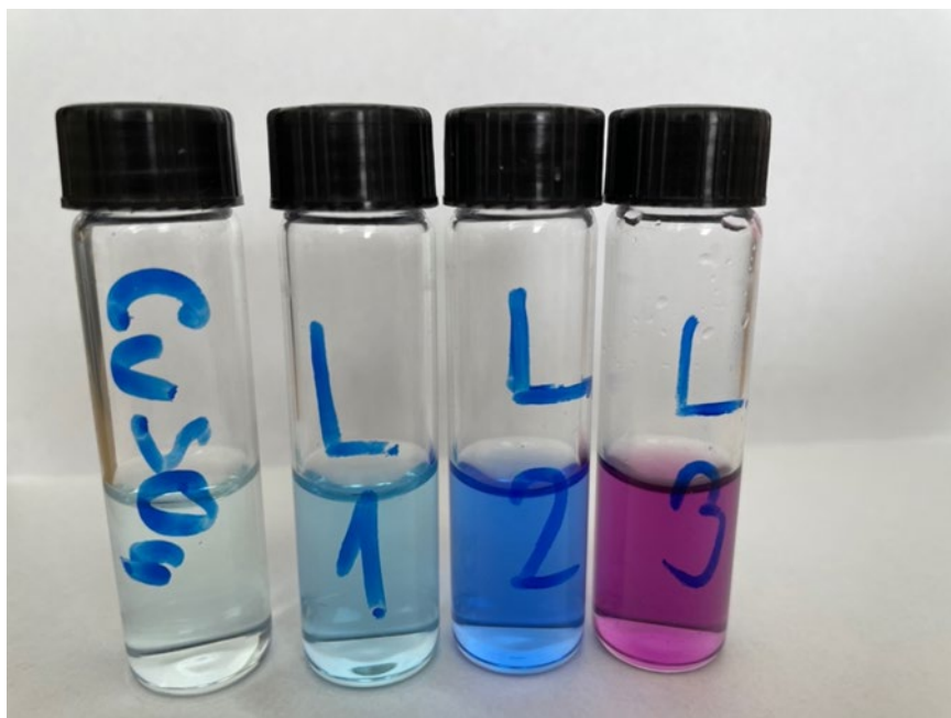
Obr. P4: Barvy roztoků \text{CuSO}_4 a komplexů \text{Cu-L}^1 , \text{Cu-L}^2 a \text{Cu-L}^3
