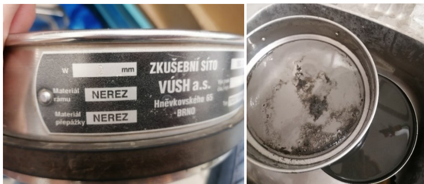
Obr. 5 – zkušební síta o velikosti oka 2 mm a 0,063 mm (fotografie autora)
