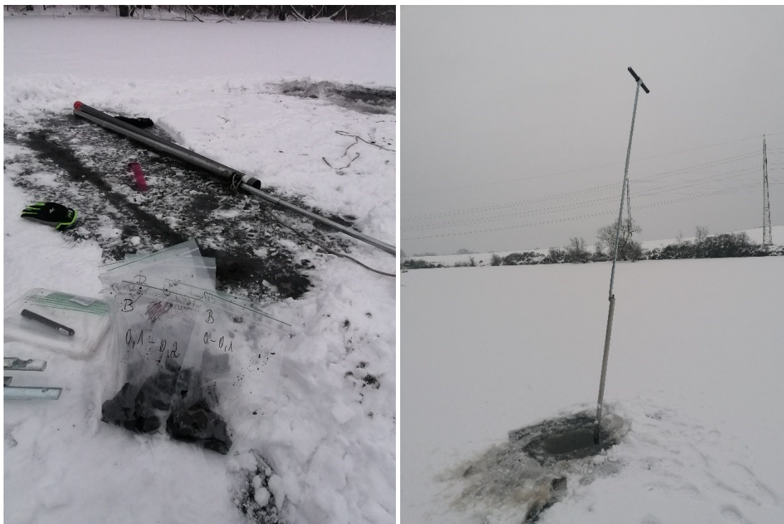
Obr. 9 – odběr sedimentu pístovým odběrákem Eijkelkamp z ledu (fotografie autora)
