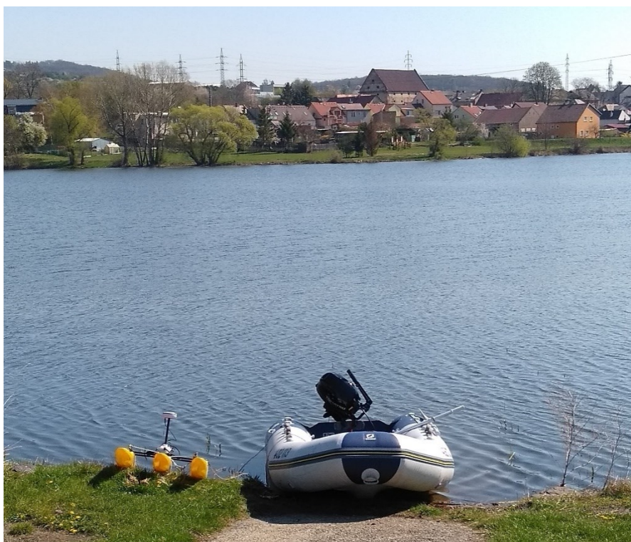
Obr. 8 – RiverSurveyor M9 umístěn na plováku, připraven na tažení za motorovým člunem (fotografie autora)
