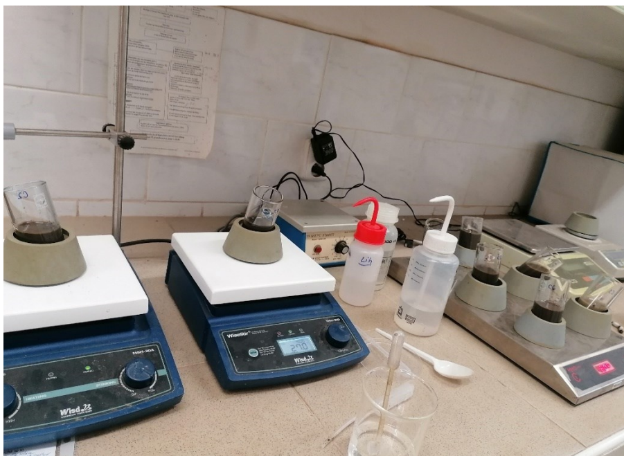
Obr. 11 – magnetické míchačky s ohřevem použité při přípravě vzorků (fotografie autora)
