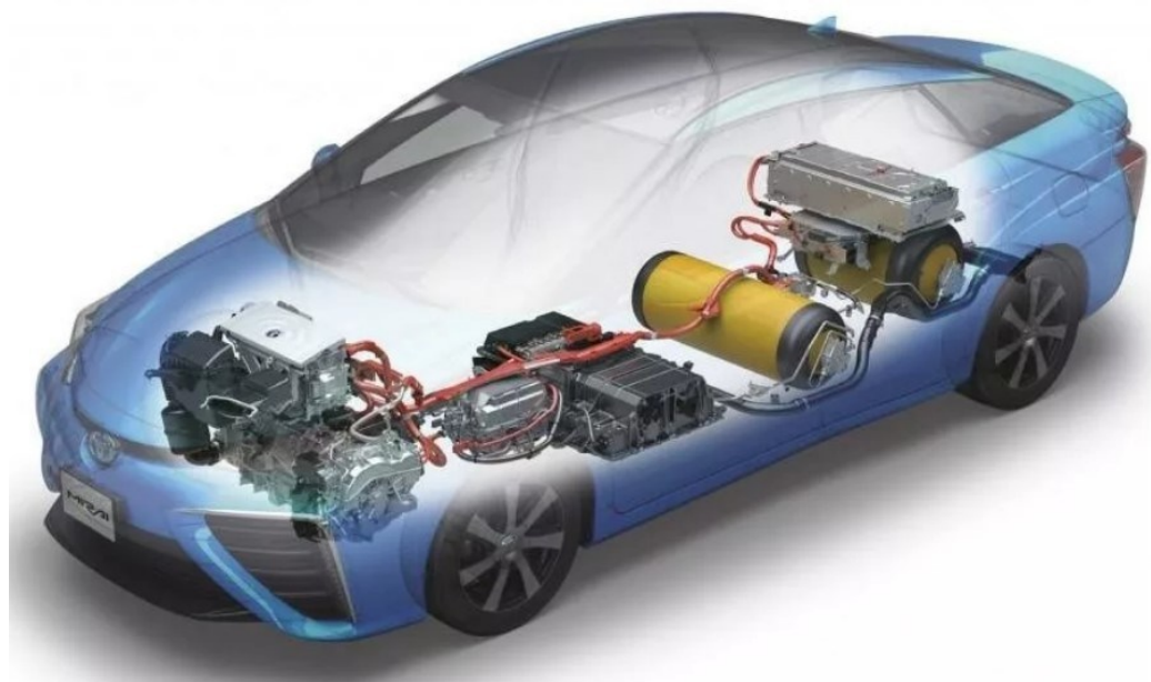
Obrázek 17. Schéma vodíkové pohonné jednotky na příkladu vozidla "Toyota Mirai"
