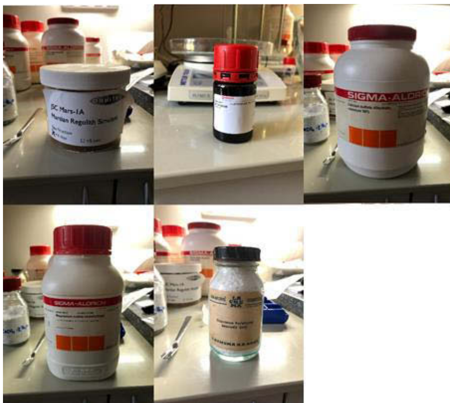
Obrázek 6: Hlavní chemické složky tohoto experimentu. Horní řada zleva: simulant marsovského regolitu, betakaroten, sádrovec. Spodní řada zleva: epsomit, chloristan.
