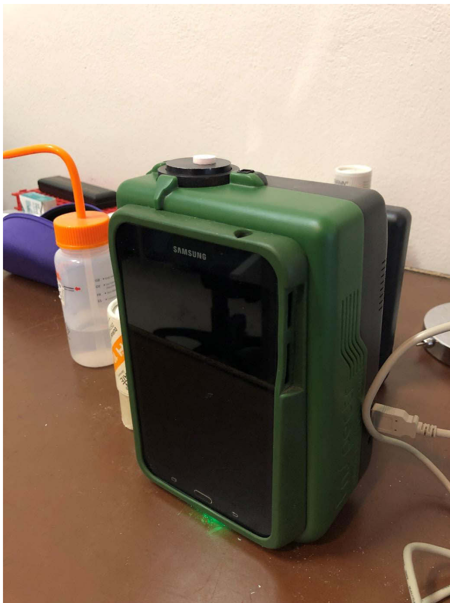
Obrázek 12: Přenosný Ramanovský spektrometr Enspectr RaPort s peletou přiloženou přímo na snímací zařízení. Takto probíhalo měření každé pelety v 10 náhodných bodech. Stínítko laseru sejmuto z důvodu pořízení fotografie.
