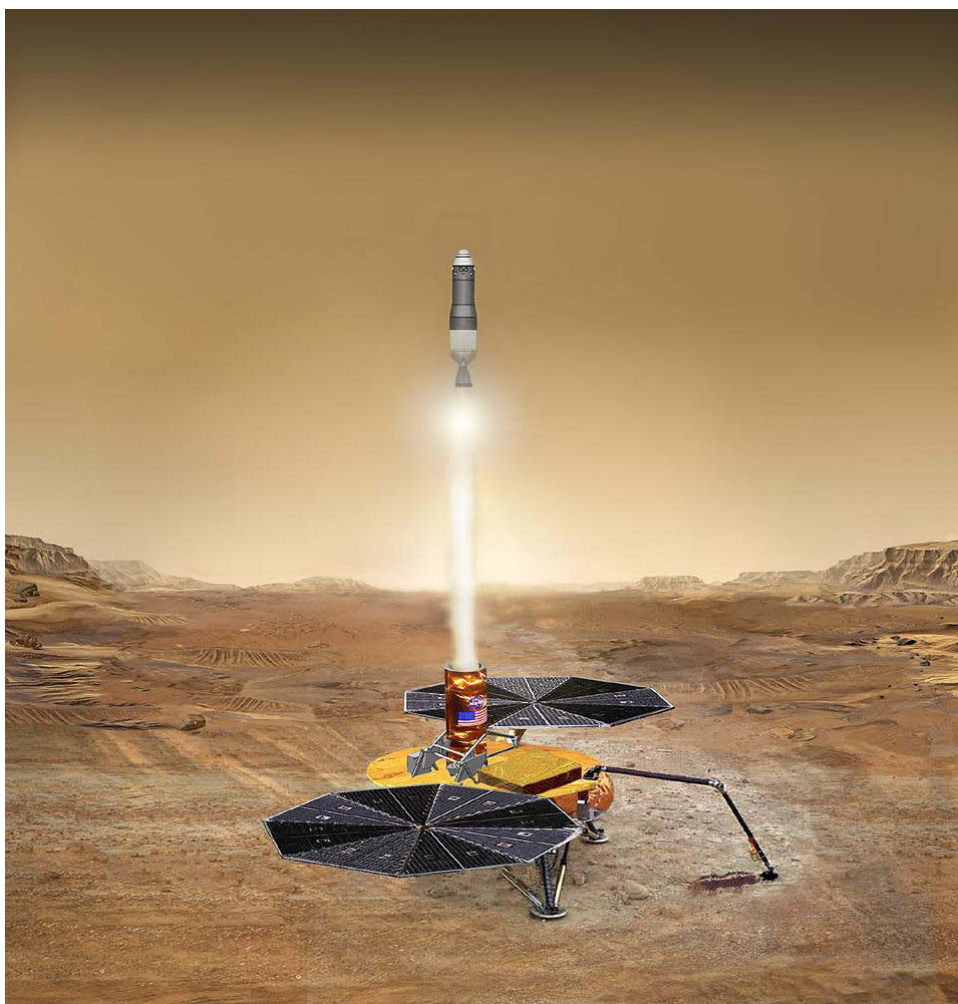
Obrázek 19: Vizualizace mise Mars Sample Return, která počítá s návratem shromážděných vzorků roverem Perseverance zpět na Zemi. Zdroj: převzato z https://www.jpl.nasa.gov/missions/mars-sample-return-msr
