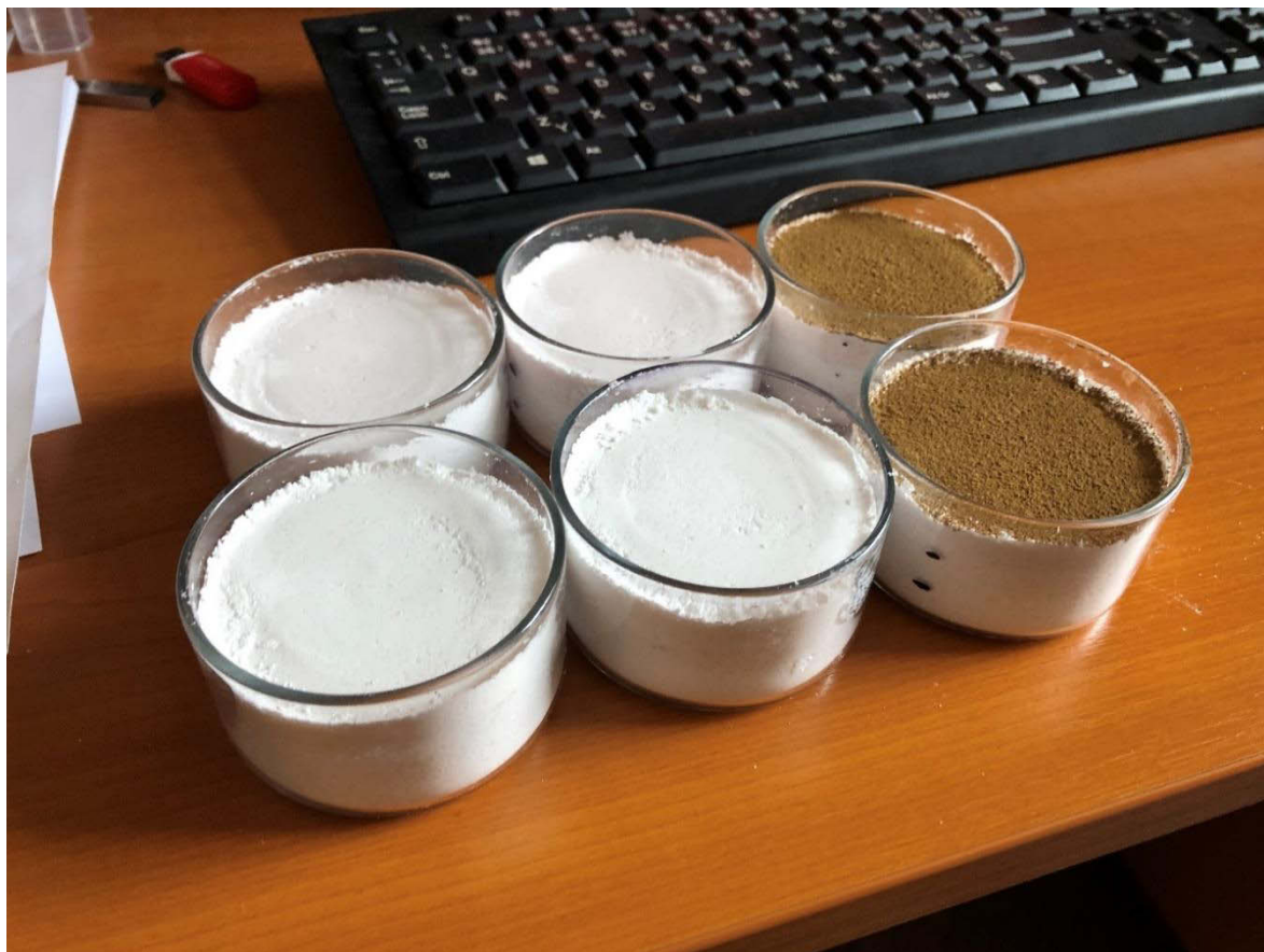
Obrázek 8: Připravené vzorky pro spuštění fáze ozařování. Zleva: kontrolní vzorky, vzorky pro ozařování bez vrstvy marsového simulantu, poslední dvojice je určena pro ozařování, ale s vrstvou simulantu marsové půdy na povrchu. Vrstva je silná cca 1mm.
