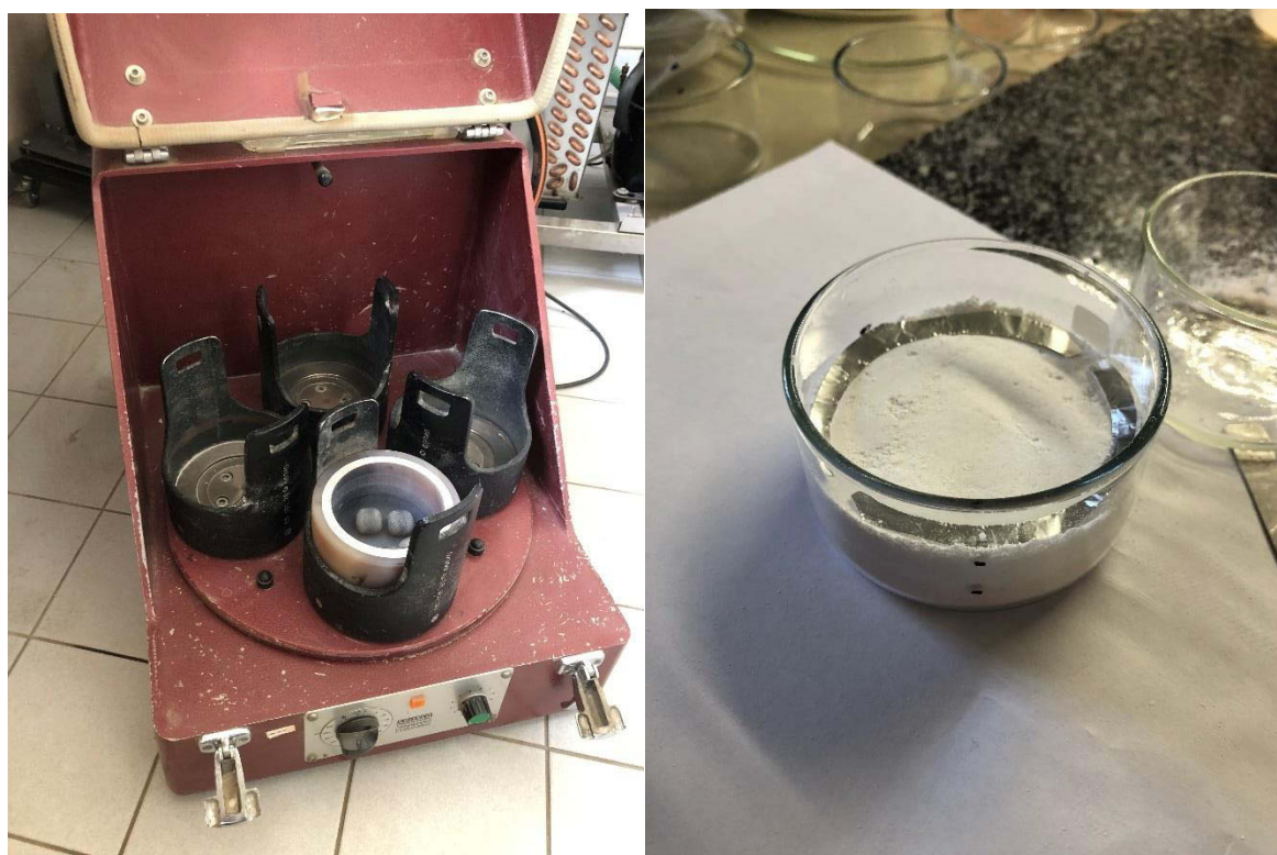
Obrázek 7: V levé části je zobrazen kulový mlýn s achátovou miskou, sloužící ke snazší homogenizaci substrátu. V pravé části je zobrazena fáze vrstvení pigmentové a čisté vrstvy substrátu do krystalizační misky. Patrné alobalové půlkruhy sloužící k oddělení vrstev substrátu.
