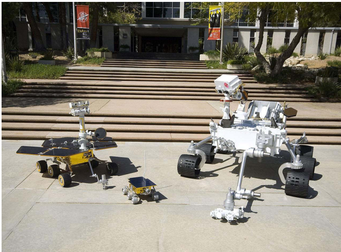
Obrázek 3: Porovnání tří generací misí marsovských roverů. Zleva: Mars Exploration Rover, Mars Pathfinder a Mars Science Laboratory. Zdroj: https://www.jpl.nasa.gov/images/pia11431-size-comparison-three-generations-of-mars-rovers
