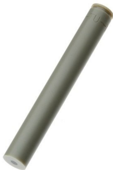
Obrázek 5 – pracovní kompozitní elektroda z ultračistého grafitu (UTGE); převzato z [22]
