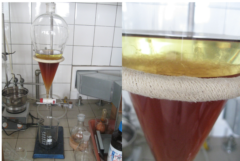
Obr. 18 a 19: Vytřepávání filtrátu s EtOAc (po vyčištění n-hexanem a alkalizaci)
