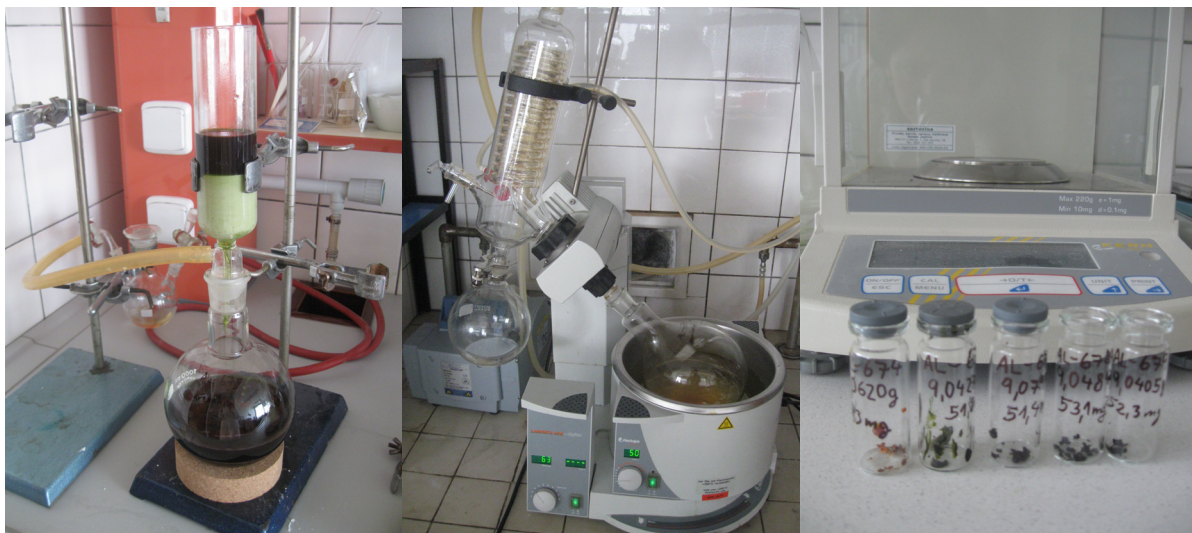
Obr. 15, 16 a 17: Vakuová filtrace přes křemelinu; odpaření rozpouštědla na rotační odparce; navážení vzorků sumárních extraktů
