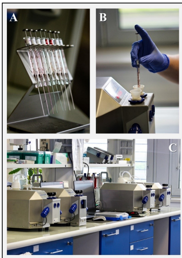
Obrázek 16. Vybavení pro měření mitochondriální respirace. A) Hamiltonovy injekční mikrostříkačky různých objemů pro přesné titrování přidávaných substrátů, inhibitorů a dalších látek v průběhu měření mitochondriální respirace v přístroji Oxygraph-2k. B) Postup titrace látky do komory \text{O}_2\text{k} pomocí Hamiltonovy injekční mikrostříkačky. Po propláchnutí a naplnění daným objemem přidávané látky je mikrostříkačka vložena do kapiláry ve stopperu a objem pomalu stříknut do komory \text{O}_2\text{k} tak, aby nedošlo ke vzniku nežádoucích bublinek plynu. C) Měření probíhalo současně ve 4 přístrojích Oxygraph-2k, tedy v 8 komorách (autor fotografií: Mudr. Lukáš Nalos Ph.D.).
