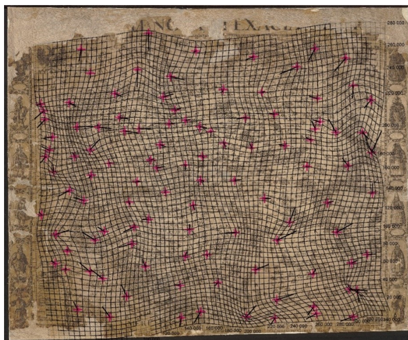
Obr. 28 Deformační síť s identickými body a jejich vektory posunů na Aretinově mapě
