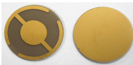
Obr. 17: Fotografie QCM s nadeponovanými elektrodami
