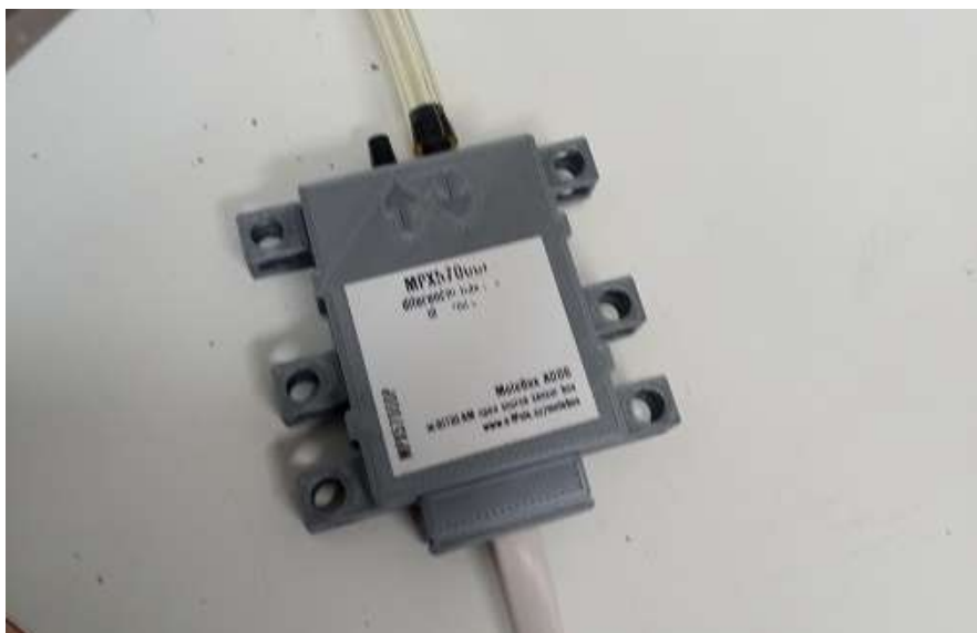
Obr. 12 – diferenční tlakoměr MPX5700DP (CNDT) čínského původu spájený k ethernetovému kabelu uvnitř 3D tištěného krytu navrženého tvůrci ŠMS Molegraph
