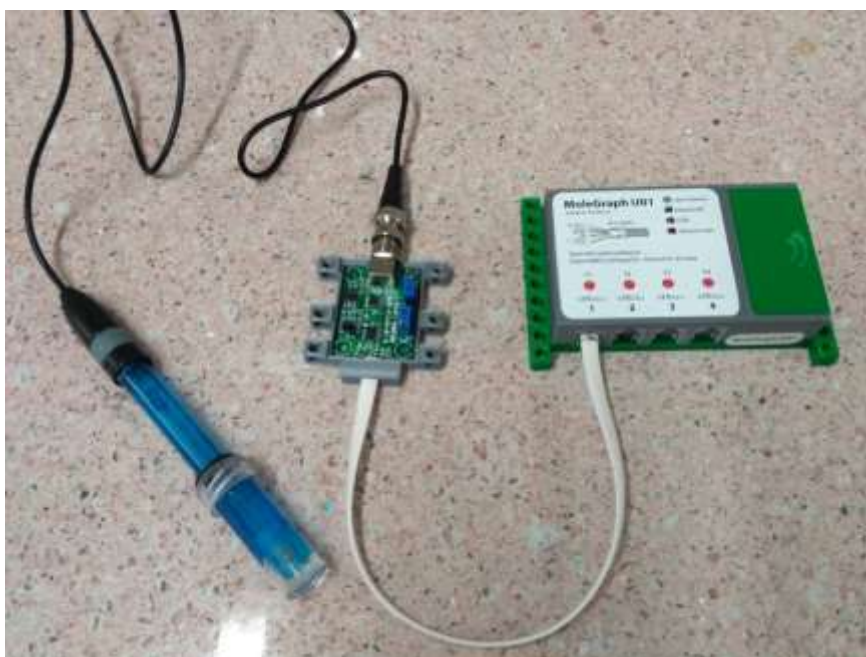
Obr. 9 – ŠMS Molegraph – Rozhraní Molegraph U01 (vpravo), do něj konektorem RJ12 zapojená součástka pH E201 (uprostřed), a k ní BNC-konektorem zapojena CNE (vlevo)
