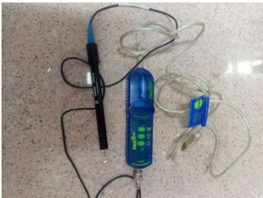
Obr. 6 – Senzor na měření vodivosti PASCO připojený k rozhraní USB Link PS-2100A
