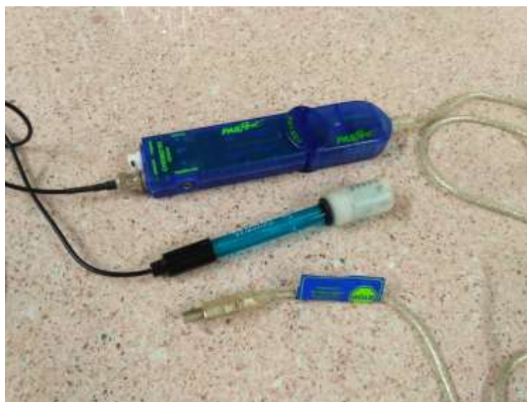
Obr. 3 – pH elektroda PASCO připojená BNC-konektorem k senzoru obecná chemie, který je připojen k USB Link PS-2100A s USB výstupem
