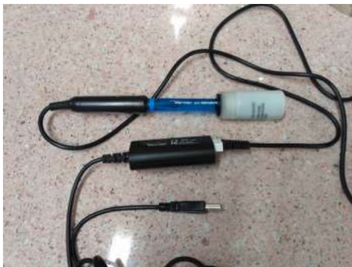
Obr. 4 – pH elektroda Vernier připojená k USB rozhraní GO-LINK s USB výstupem
