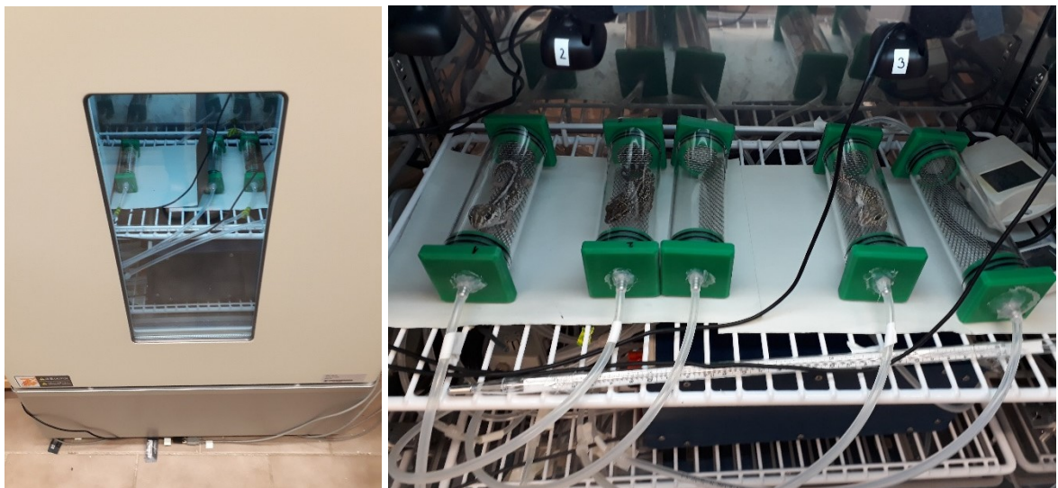
Obr. 17: Respirometrické komůrky umístěné v klimatickém boxu (vlevo). Design experimentu (vpravo) 5 komůrek: 1., 2., 4. a 5. – komůrky pro měřená zvířata; 3. referenční prázdná komůrka (v průběhu samotného měření byla mezi komůrky umístěna papírová přepážka, aby na sebe měření jedinci neviděli a nerušili se a vždy byla kontrolována a zaznamenávána teplota za pomoci dataloggeru a kalibrovaného teploměru.
