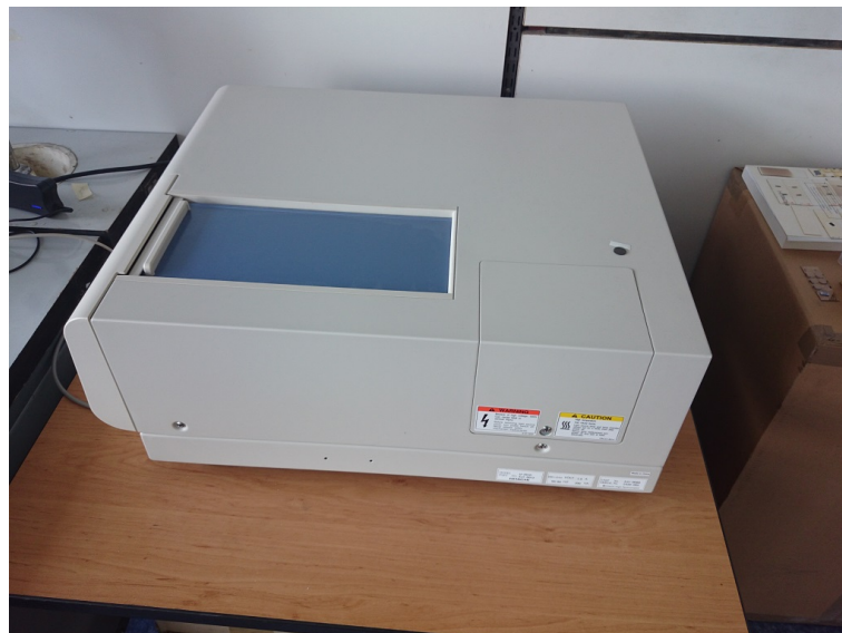
Obrázek 19: UV-Vis Hitachi U-2900.
