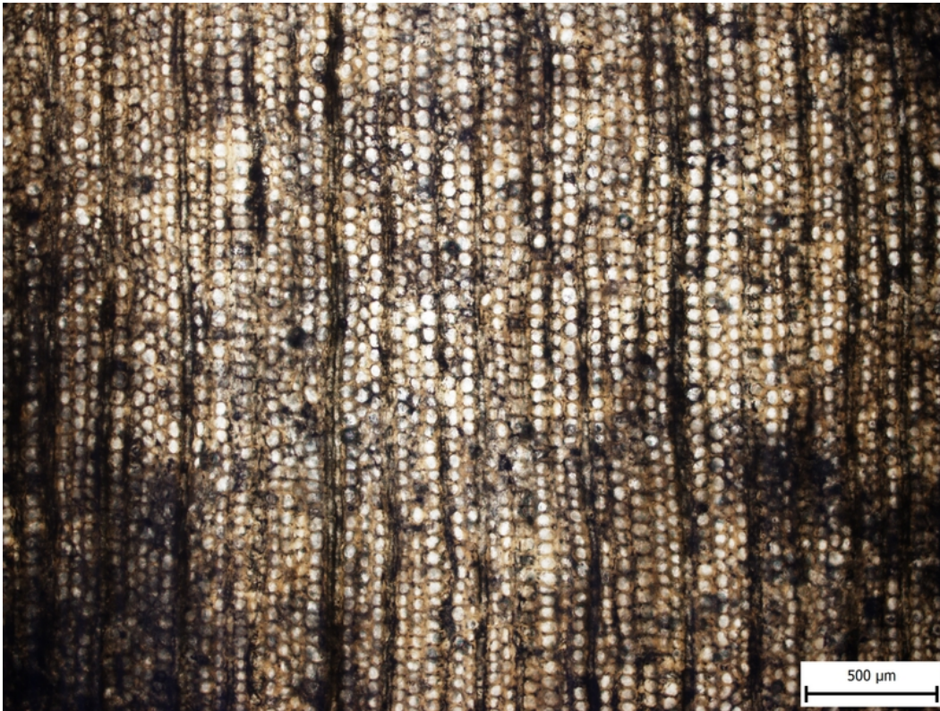
Obrázek č. 5. Jehličnan, vzorek Cep06, příčný řez.
