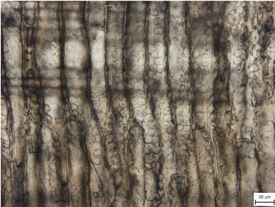
Obrázek č. 7. Jehličnan, vzorek Cep06, radiální řez, abietoidní tečkování na tracheidách.
