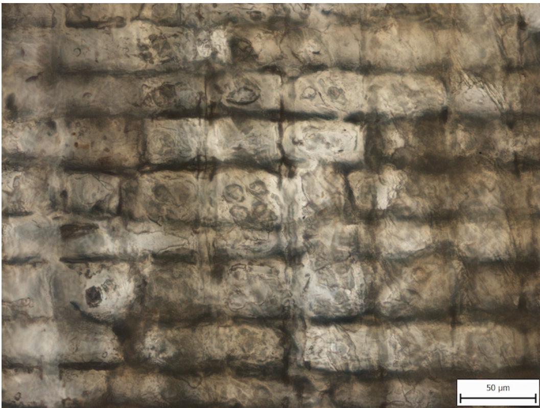
Obrázek č. 8. Jehličnan, vzorek Cep06, radiální řez, křížové pole s tečkami.
