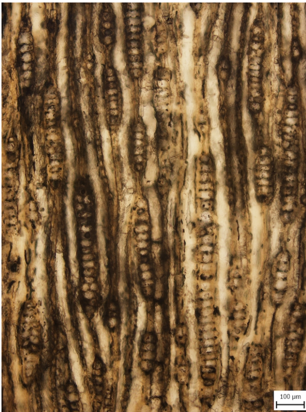
Obrázek č. 10. Jehličnan, vzorek Cep06, tangenciální řez, dřevové paprsky.
