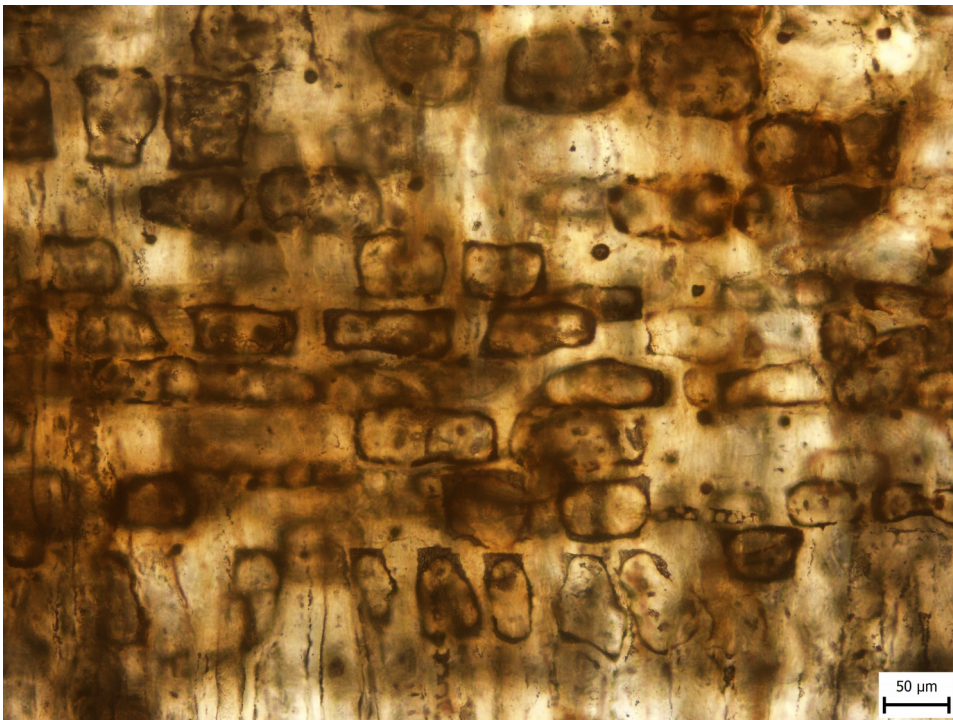
Obrázek č. 14. Paraphyllanthoxylon , vzorek LH6, radiální řez, heterogenní paprsky.
